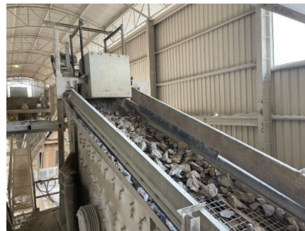
รูปที่ 2-26: การปิดคลุมตะแกรงร่อน
